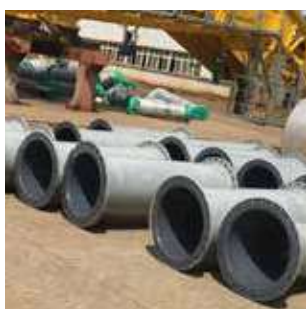
Tubería para agua de lastre
